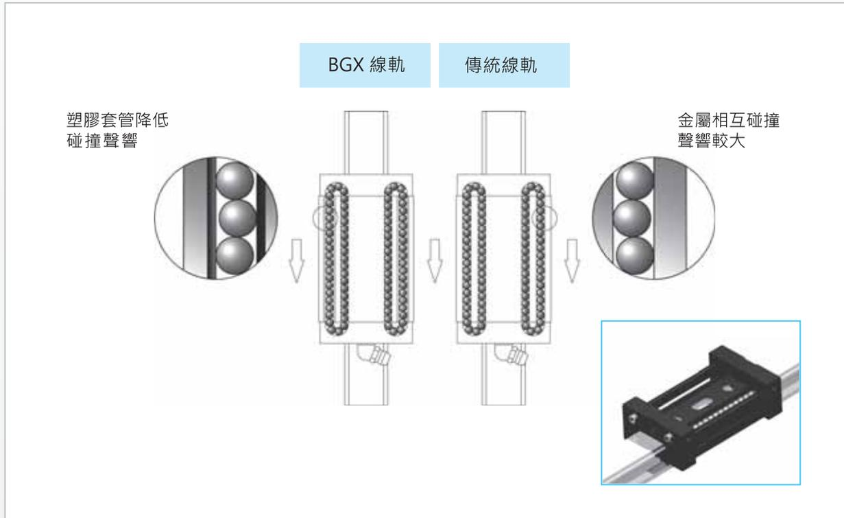
高分子聚合物套管，其材質可大幅減低滑座，高速運行鋼珠碰撞聲響。
